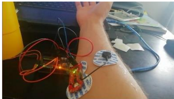
Fig. 8. Posicionamiento del sensor y los electrodos en el antebrazo. (Fuente: Autores)
