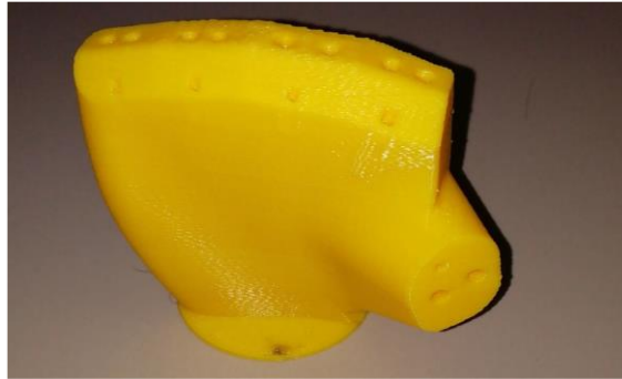
Fig. 9. Pieza impresa en representación de la palma de la mano. (Fuente: Autores)
