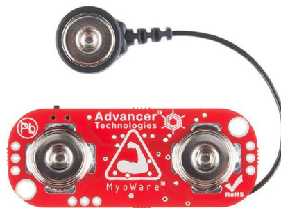
Fig. 2. Características del sensor MyoWare. (Fuente: Sandorobotics, 2019).
