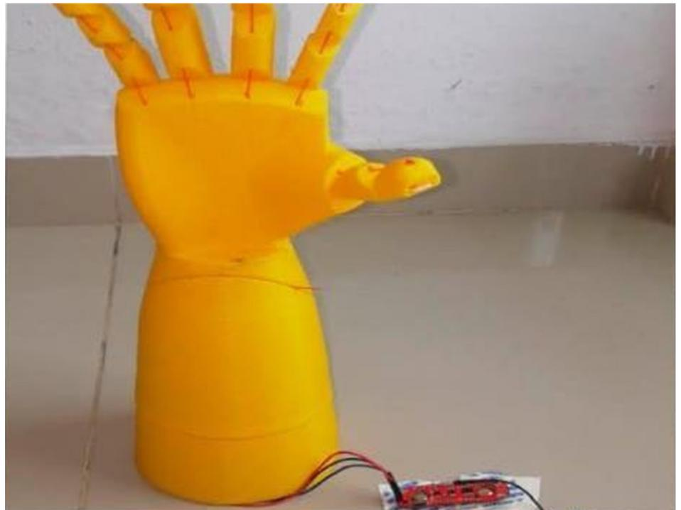
cular "MyoWare" que mide la actividad eléctrica filtrada rectificada en un músculo para lograr el movimiento. La prótesis, permitirá realizar movimientos de flexión y extensión de la mano, con capacidad de manejar señales mioeléctricas y su costo según
