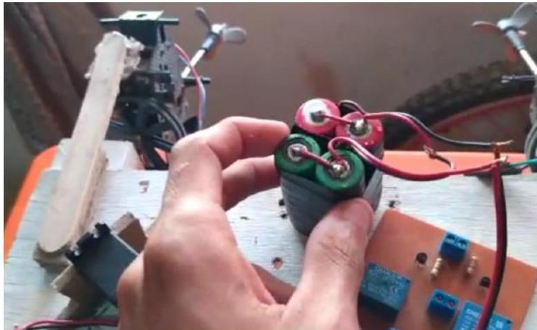
Figura 2. Fabricación de bando de baterías. Fuente (autor).
