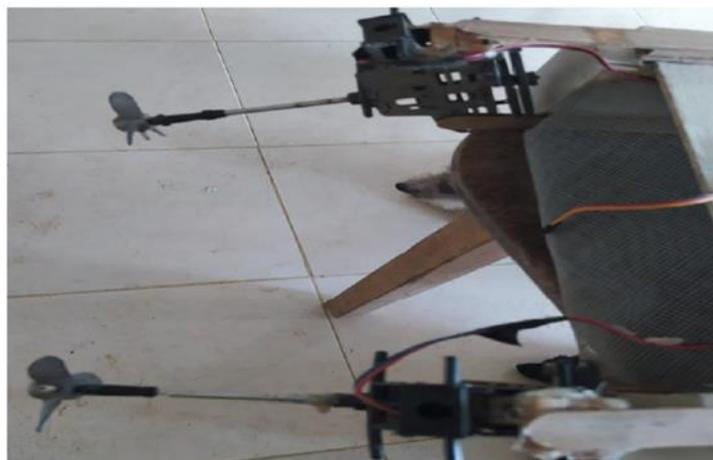
Figura 4. Instalación de los motores DC. Fuente (autor).
