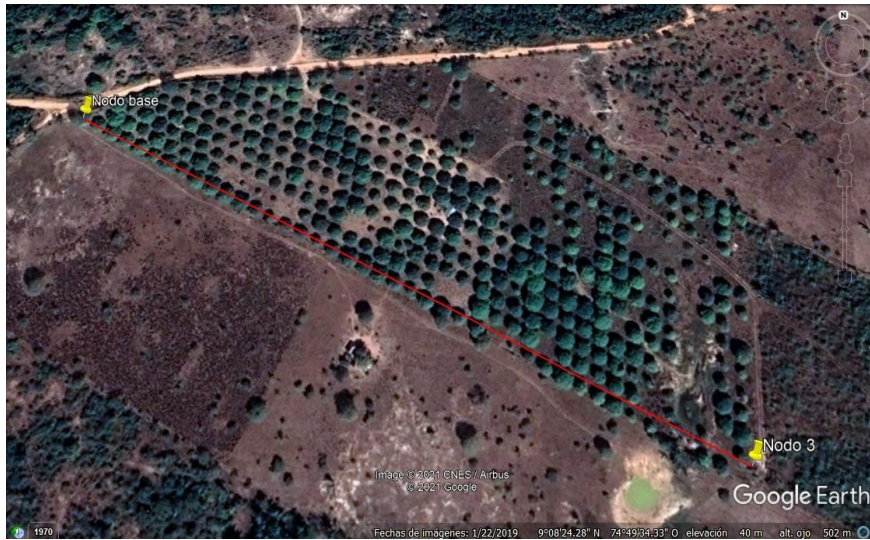
Figura 5. Planteamiento del tercer enlace Nodo Base – Nodo 3 con 500 metros de distancia entre sí
