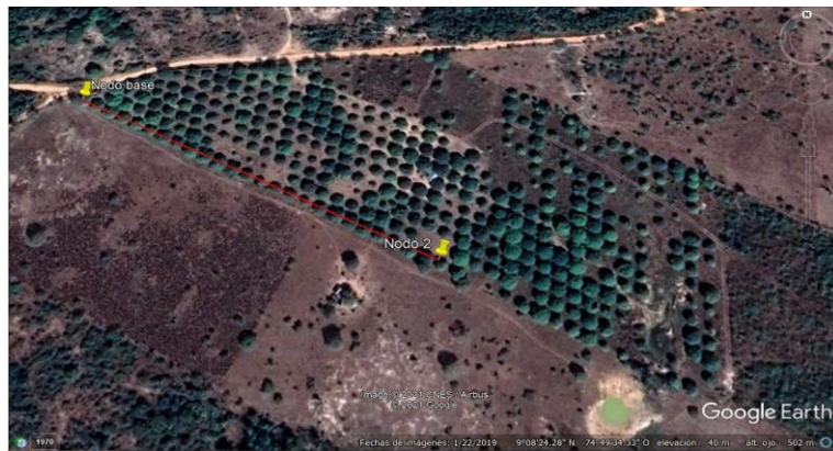
Figura 4. Planteamiento del segundo enlace Nodo Base – Nodo 2 con 300 metros de distancia entre sí
